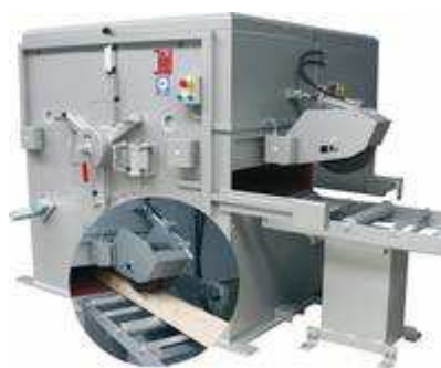
Obr. 30 Omítací pila S/GL
