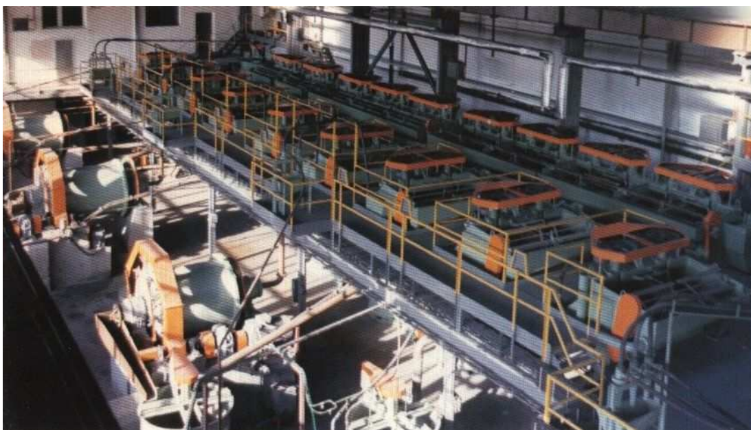
Obr. 29: Flotační linka v úpravně grafitu. Netolice (převzato: Tichý, 1995).
