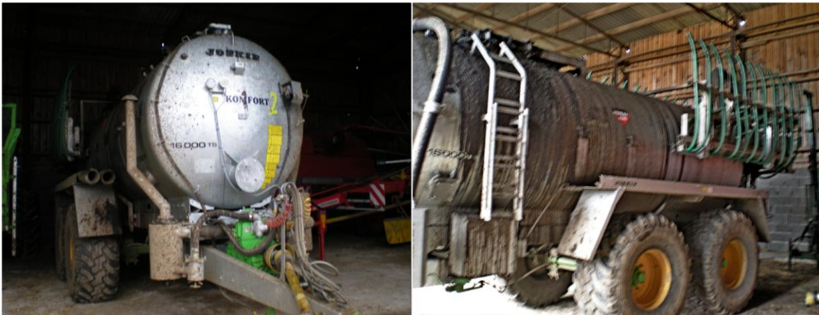
Cisternu na zapravení digestátu do půdy využívala farma až do zámru
