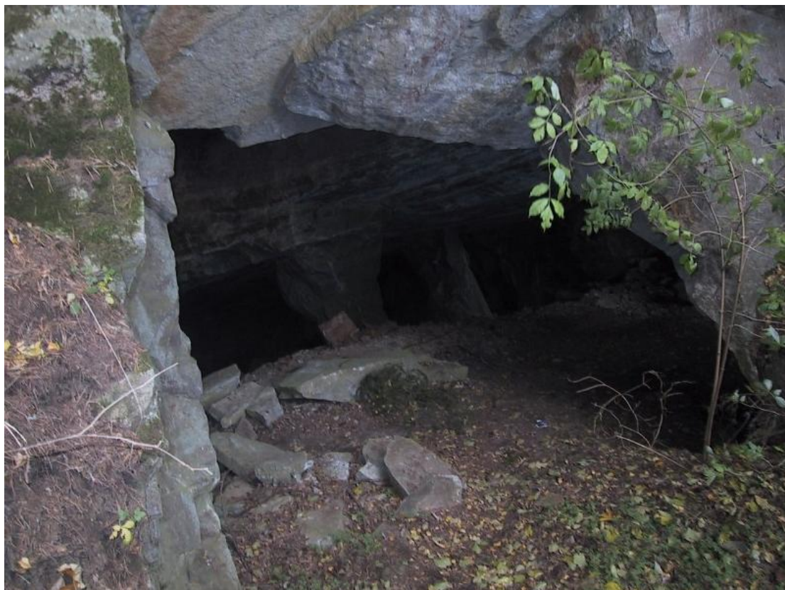
Vápencové jámové lomy s ponechanými opěrnými skalními pilíři.
