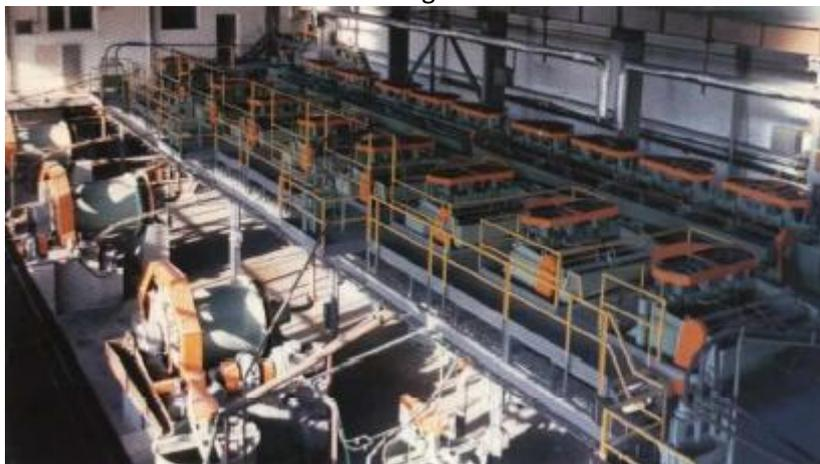
Flotační linka v úpravně grafitu v Netolicích
