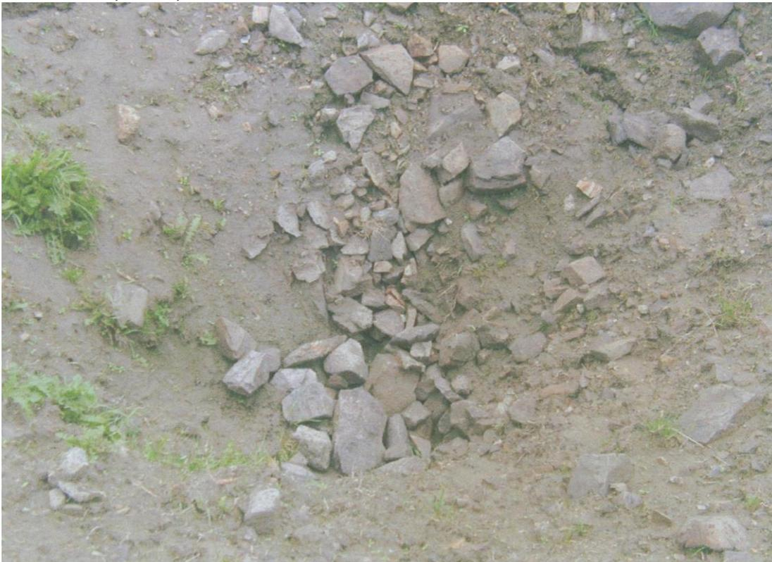
Obr. 5 : Propadnutý terén – detail dna
