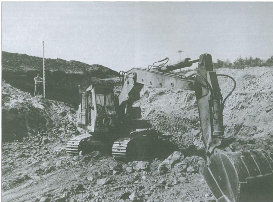
**Obr. 2:** *Zaměřování nového povrchu při těžbě severního úseku východní grafitové polohy ložiska Městského vrchu v C. Krumlově. Vpravo (načervenatá) limonitická zvětralina na styku s podložními krystalinickými vápenci*
